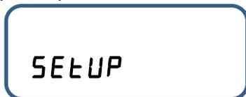
Если отпустить кнопку в этот интервал времени, счетчик перейдет в режим **Установка (Setup)**.
