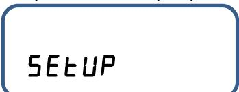
Якщо відпустити цю кнопку протягом цього інтервалу часу, лічильник перейде у режим **Встановлення (Setup)**.
