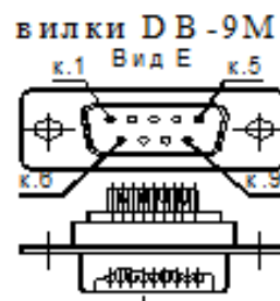
Рис. 9в. Вилки DB-9M и DB-9F
